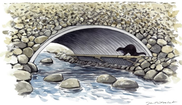
Kuva 1. Kaarisilta saukkosillalla varustettuna. Siltojen asentamiseen on omat erilliset ohjeensa.
