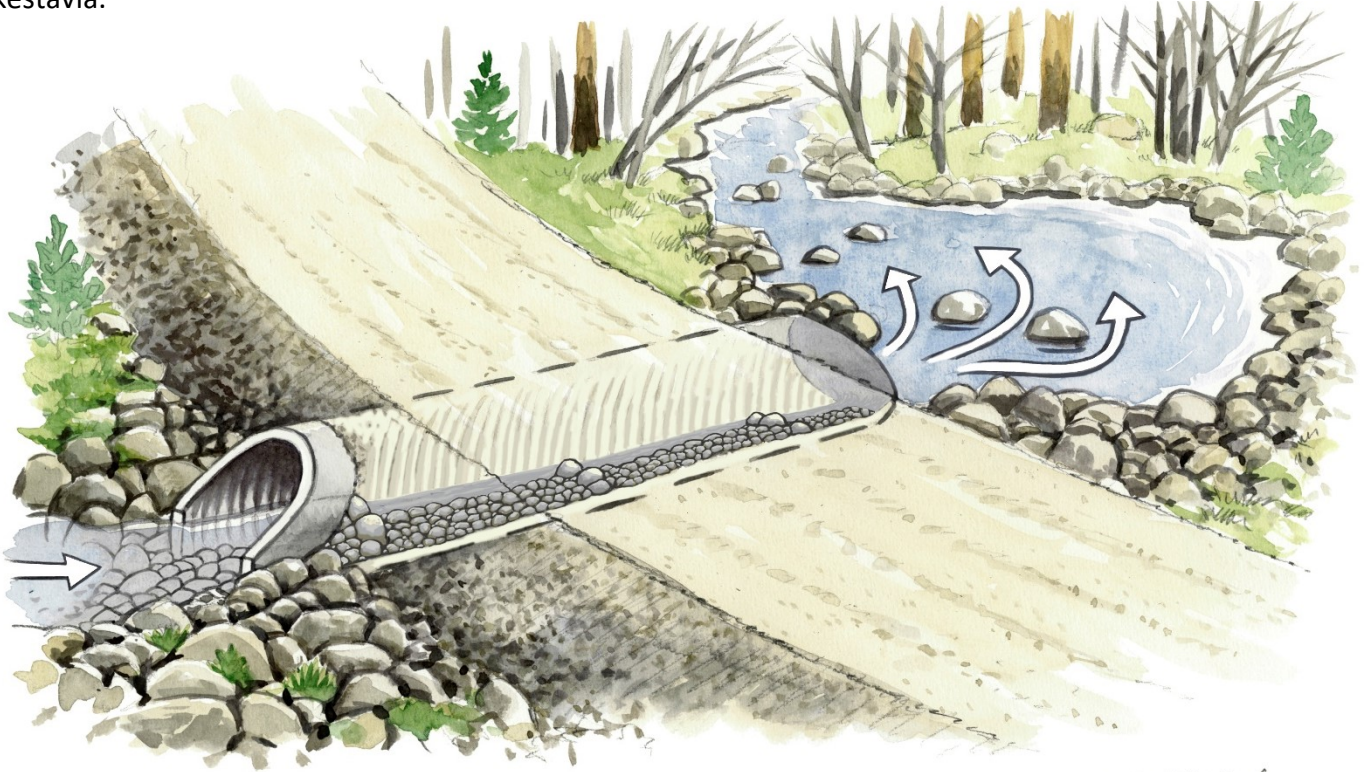
Kuva 2. Rummun asennussyvyys, vesisyvyys vähintään 20 cm.
