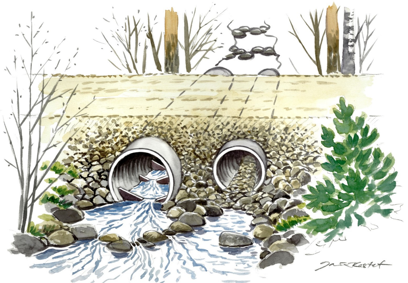
Kuva 7. Virtausnopeutta hidastavat kivet ja virtauslamellit rummussa.
