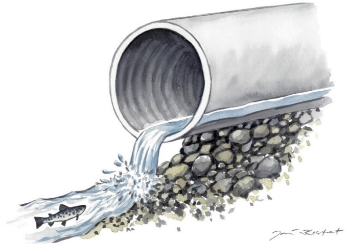
Kuva 10. Rummun alapään pudotus ja veden vähyys.
